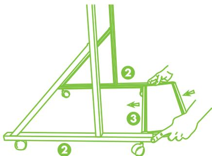
**5.** Prenda o suporte do bloco como na figura utilizando os parafusos (C) e os manípulos.
