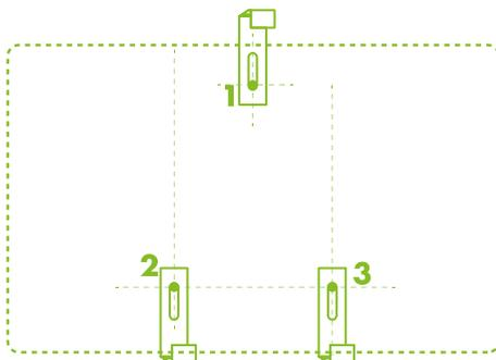
**Suportes (F)** - Fixe os suportes com os parafusos (B) e buchas (D) sendo os inferiores com o apoio virado para cima e o superior com o apoio voltado para baixo, conforme a figura acima.
