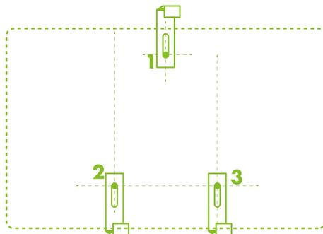
**Suportes (D)** - Fixe os suportes com os parafusos (A) sendo os inferiores com o apoio virado para cima e o superior com o apoio voltado para baixo, conforme a figura acima.
